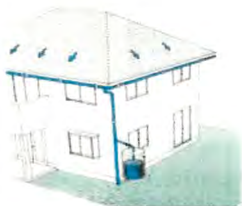
図 16 各戸貯留施設の例(地上タイプ)
