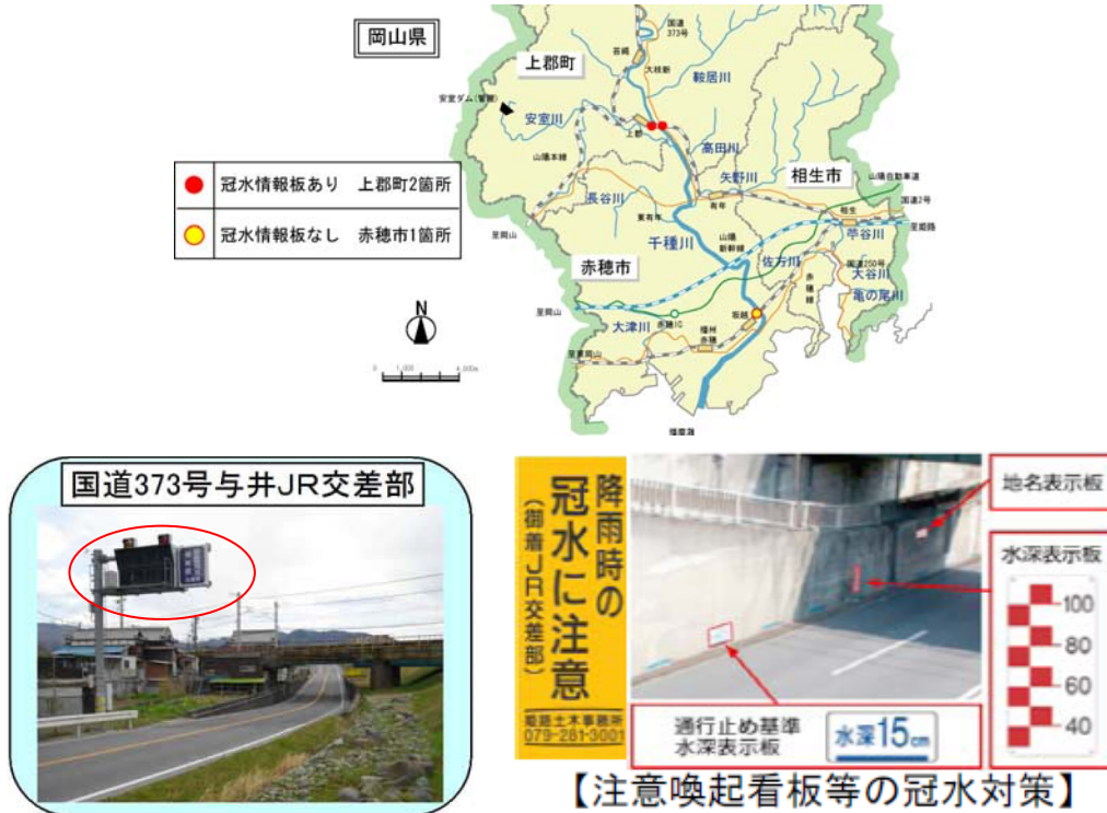
図 44 アンダーパス冠水情報板などの設置状況
