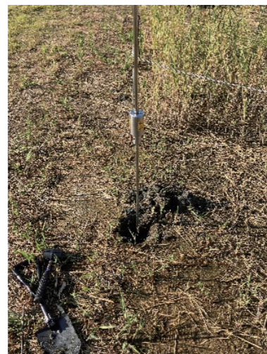
(貫入機材：検土杖)
