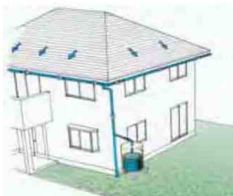
図 5-11 各戸貯留施設の例(地上タイプ)
