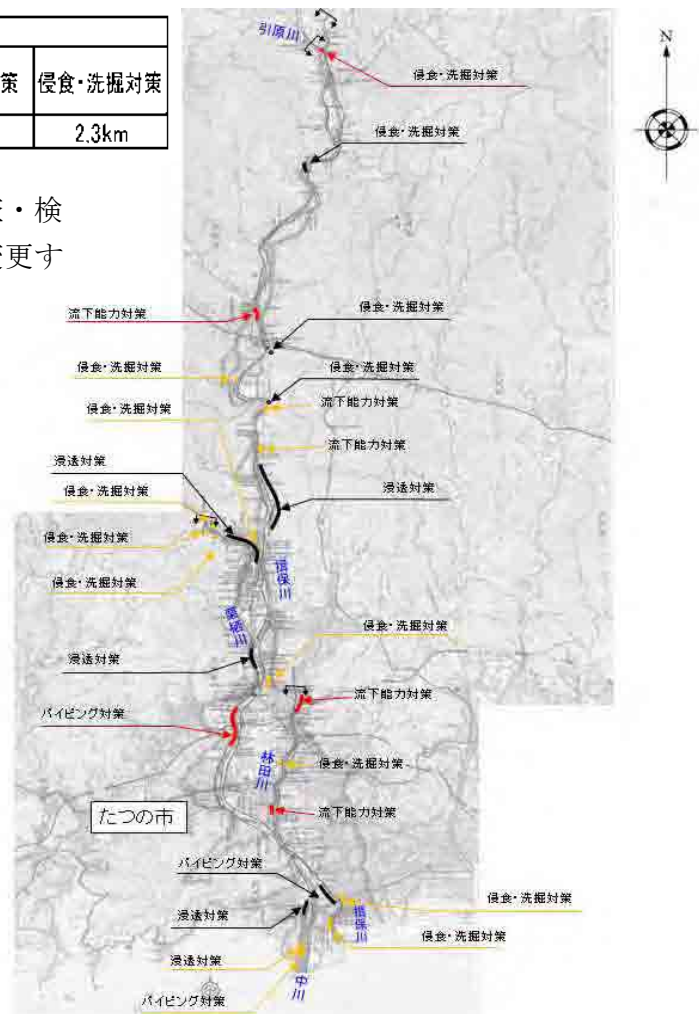
図 4-36 対策位置図 (堤防の浸透、侵食、洗掘)
