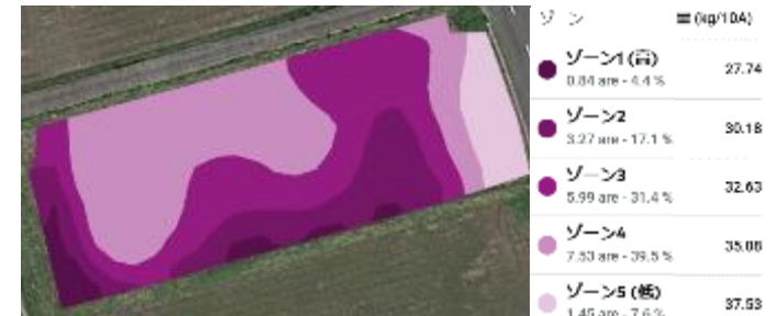
衛星画像による地力解析により自動生成した可変施肥マップ
