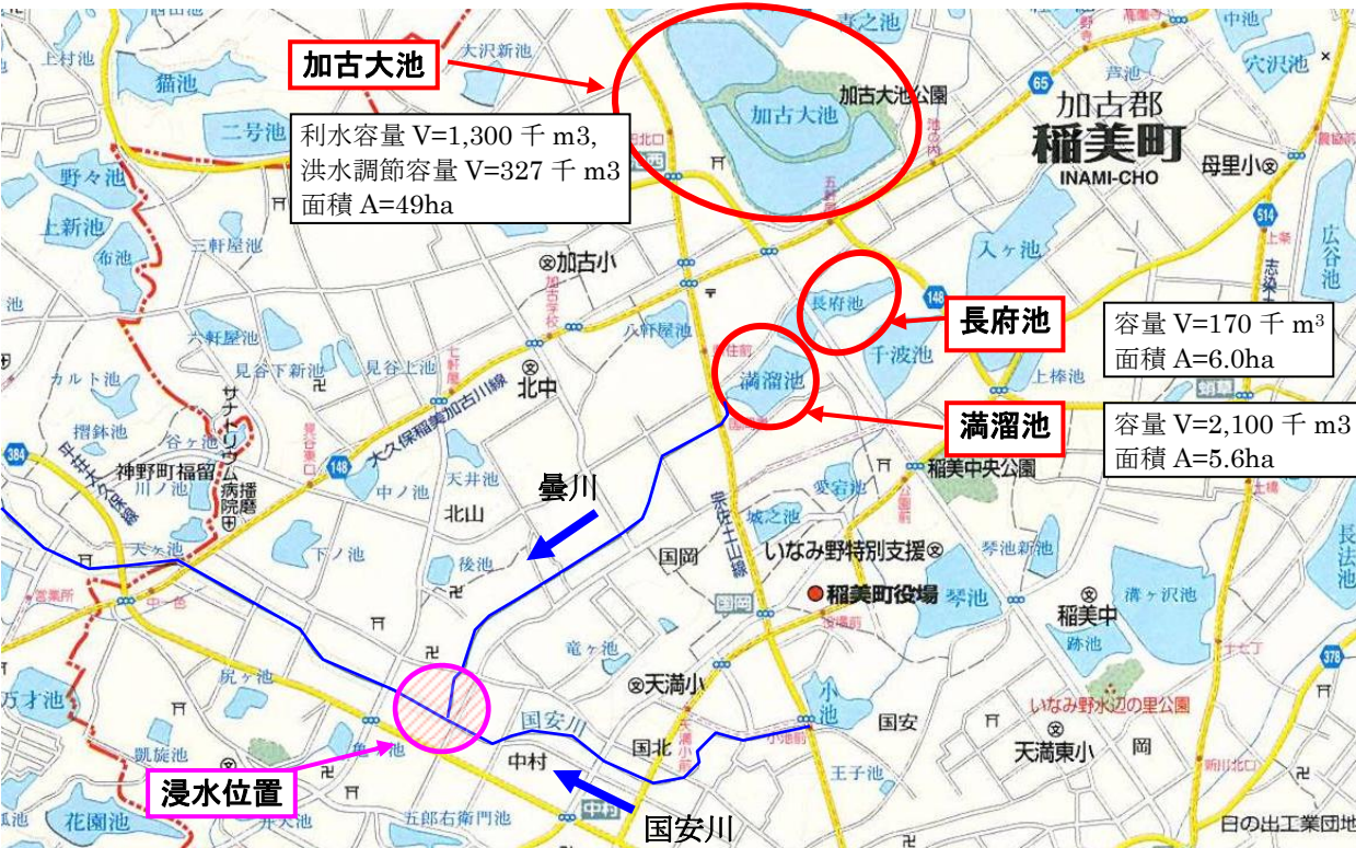
洪水調節機能をもたせた洪水吐を設置 (加古川流域土地改良事務所)
