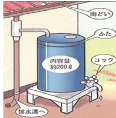
各戸貯留の貯留タンク
