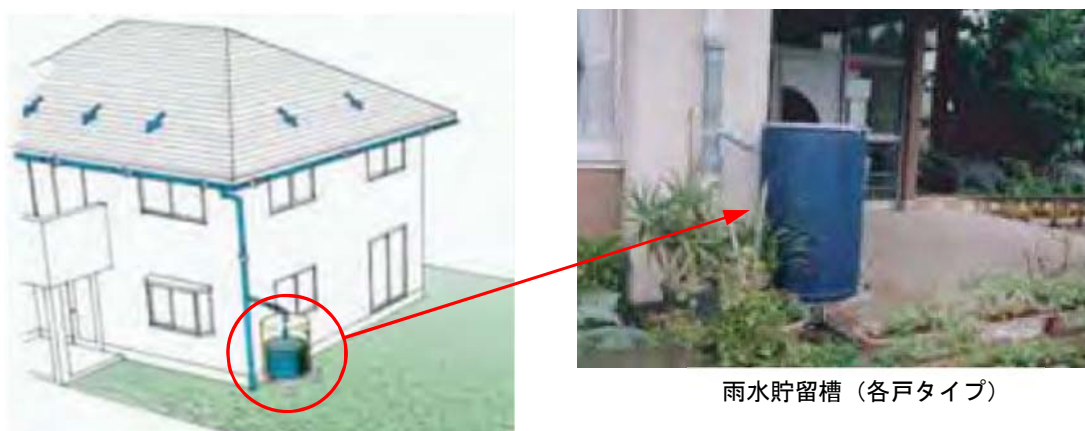
図 5.2.8 各戸貯留施設の例（地上タイプ）
