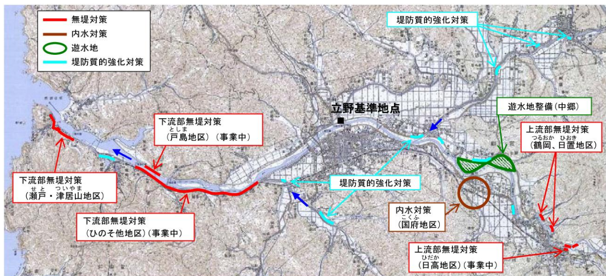
図 1.3.3 円山川水系河川整備計画（国管理区間）における整備箇所位置図 (2013（平成 25）年 3 月策定の「円山川水系河川整備計画（国管理区間）」より)
