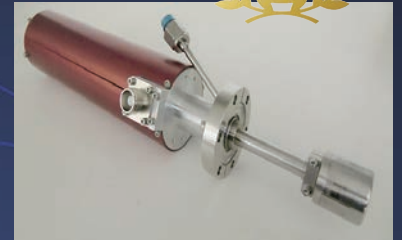
真空容器内の圧力勾配現象を用いた世界初スパッタ成膜装置 ケニックス(株)
