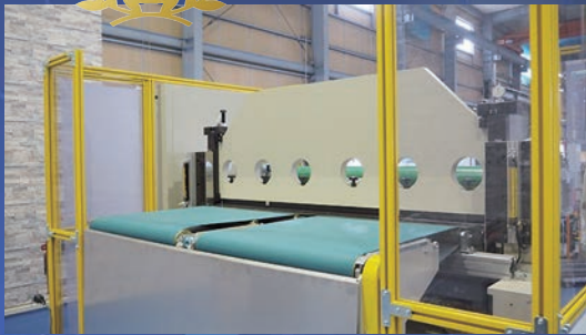
切粉レス インライン樹脂シート切断機 甲南設計工業(株)
