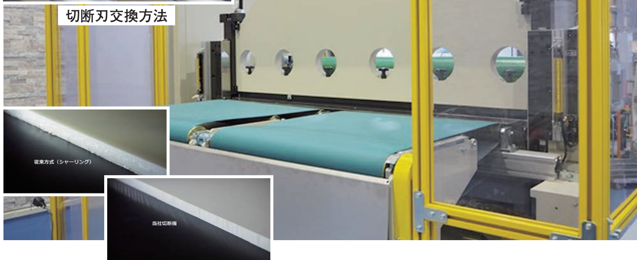
切断面: (上) 従来方式、(下) 押切方式
