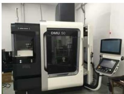
【先端加工機器(5軸マシニングセンタ)】
