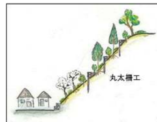
人家裏の危険斜面で 簡易防災施設を重点整備
