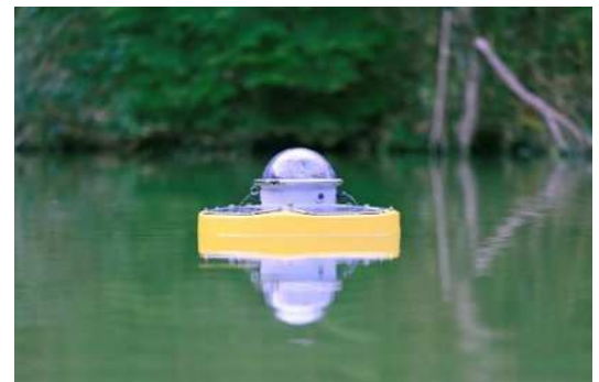
▲水面上に浮かべたブイ型水面センサー
