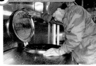
集乳する前にサンプリング検査(アルコール検査・官能検査など)や計量を実施。
