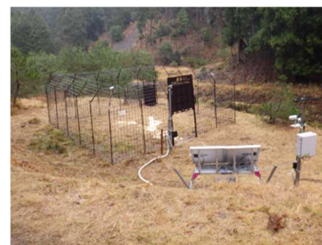
【遠隔監視・操作が可能な捕獲施設】
