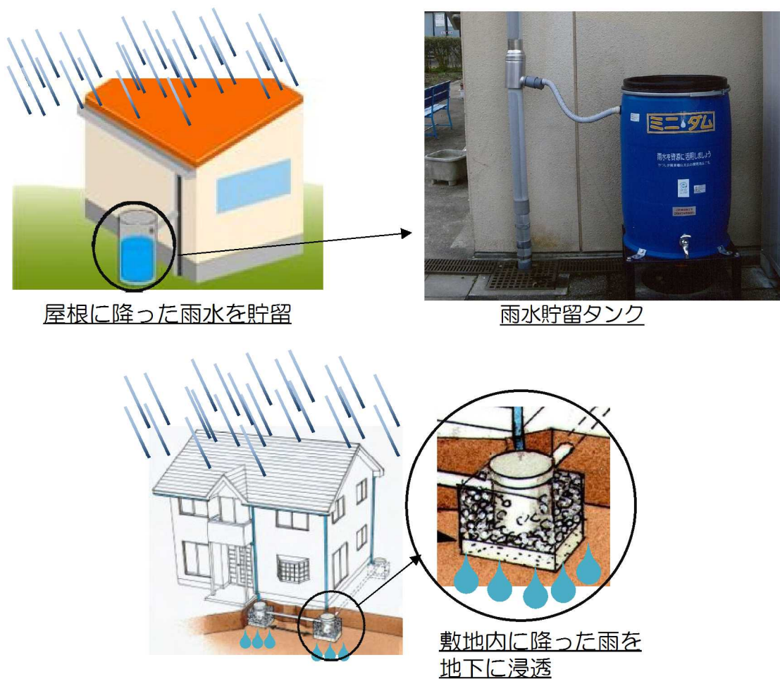
図 47 雨水貯留浸透（各戸）
