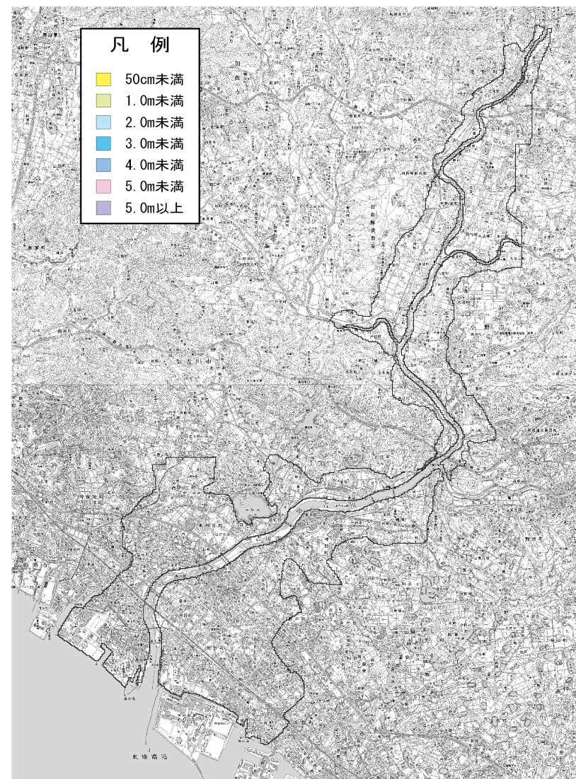
河川整備計画における予定事業実施後の氾濫想定 (整備計画規模洪水)
