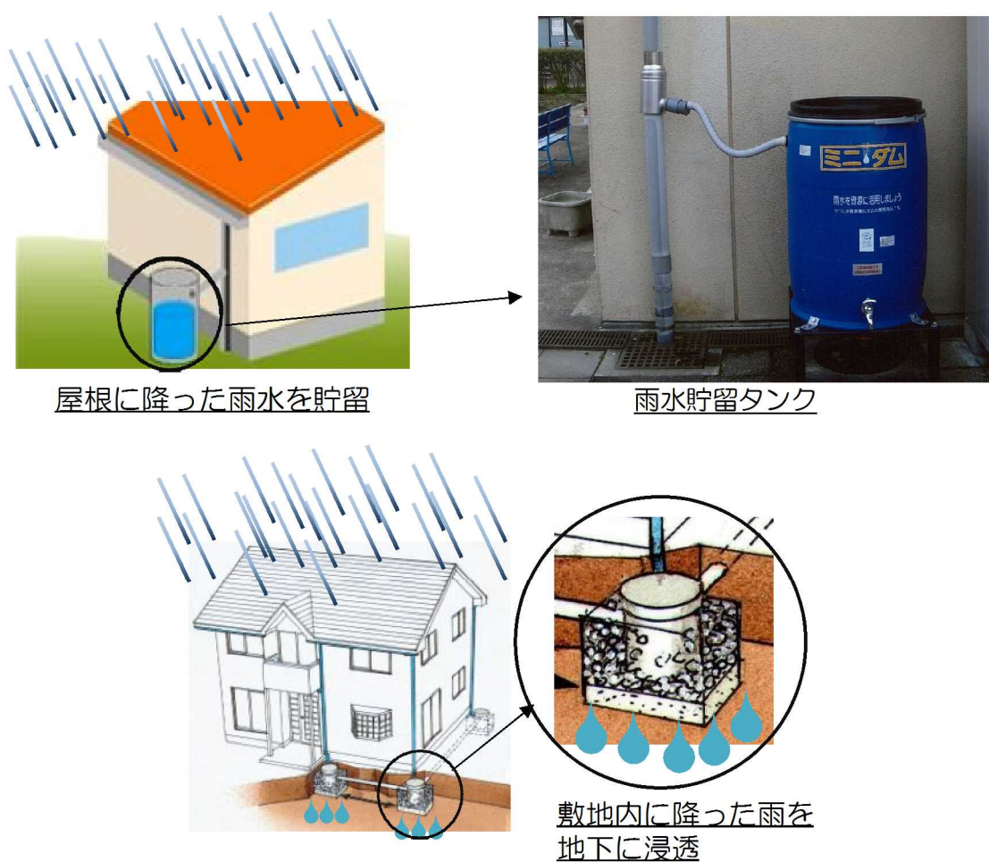
図 50 雨水貯留浸透（各戸）
