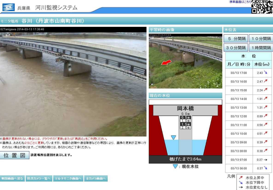
図 60 河川のリアルタイム監視画像例 (兵庫県河川監視カメラシステム URL: http://hyogo.rivercam.info/ )
