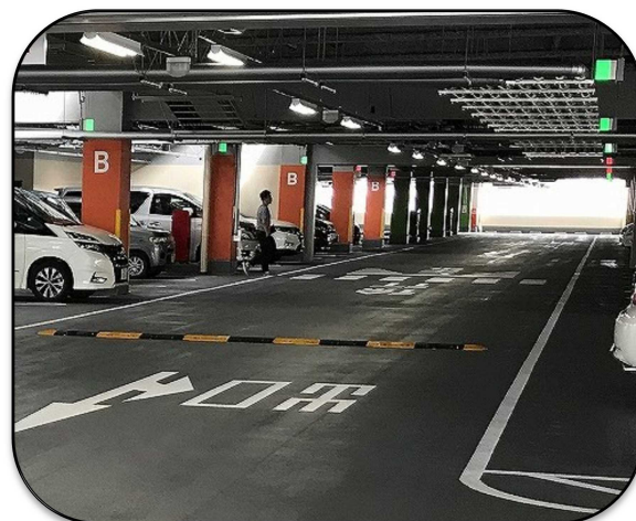
○バンプの設置
