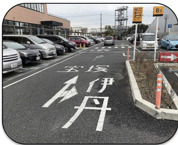
○方面別に出口を誘導する路面標示
