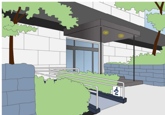
メインエントランスの段差をスロープで解消
