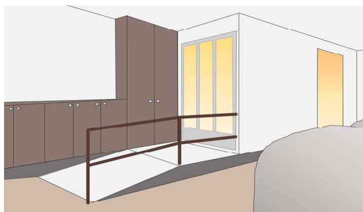
ユニットバスの段差をスロープで解消
