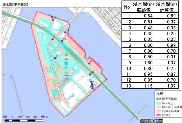
最大浸水深分布図は「大阪湾港湾等における高潮対策検討委員会」で示された高潮及び波浪の推算結果をもとに兵庫県が潮位・高波再現シミュレーションを実施し作成
