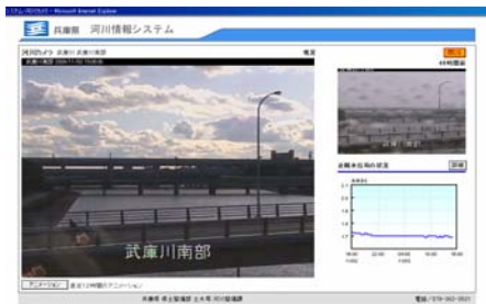
写真 4. 1. 4 河川監視カメラ画像の配信
