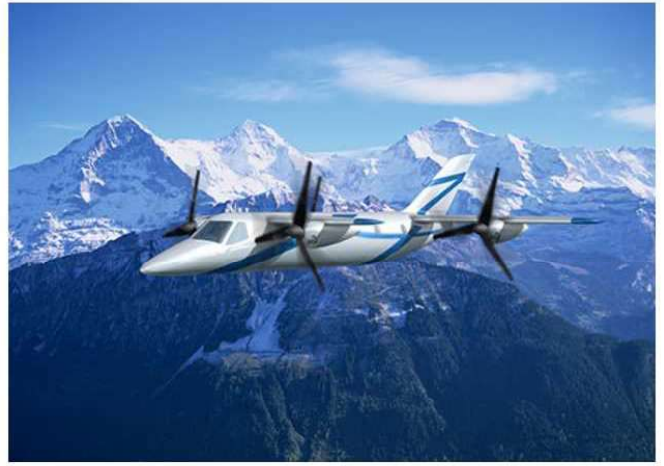
将来型4発ティルトウィング (QTW: Quad Tilt Wing) VTOL旅客機概念
