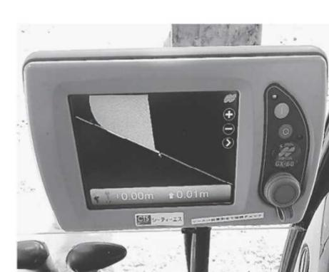
「ICT建機」のモニター画面の面の傾斜とバケットの位置が正確に把握できることで、オペレーターの作業負担につながっている。
