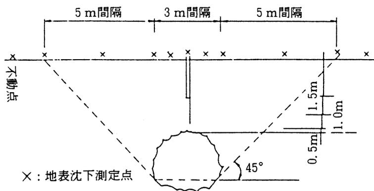
図 6 - 9 地中沈下測定点の配置例
