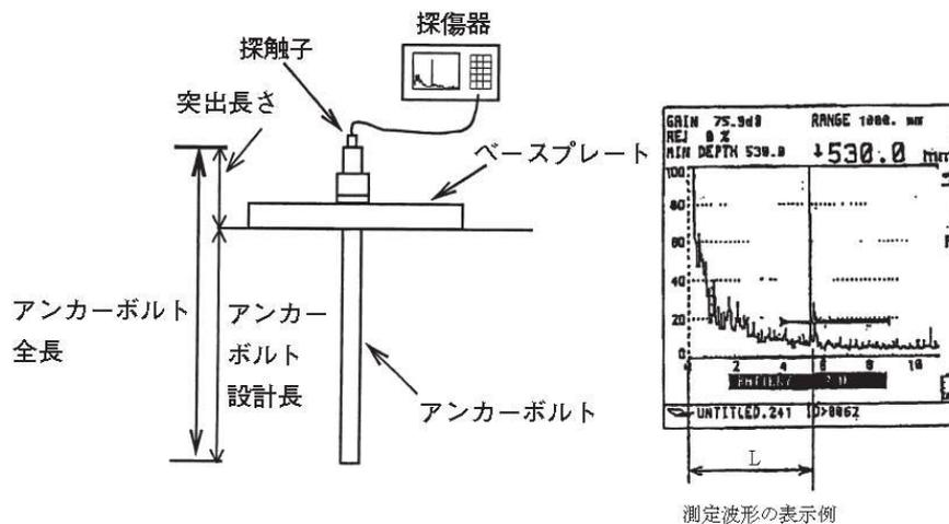
アンカーボルト長さの測定の例
