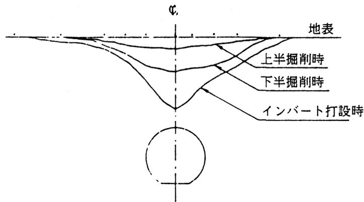
図 6-13 地表沈下分布（横断方向）
