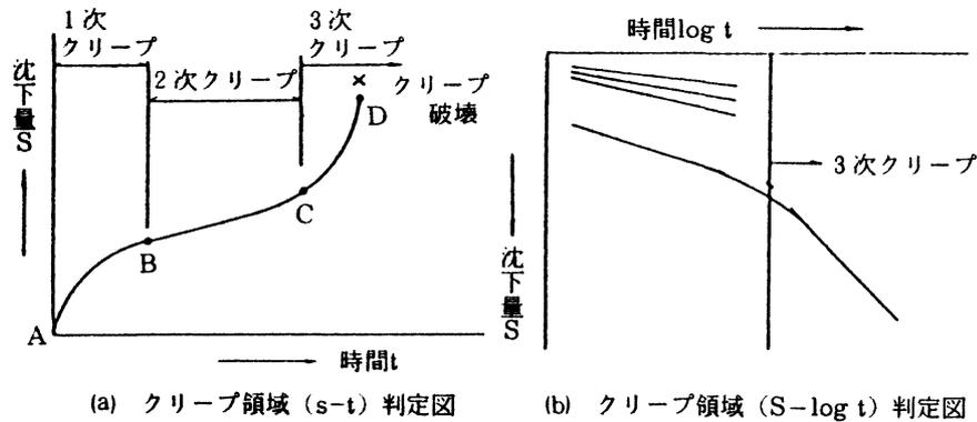
図5-1 天端沈下のクリープ領域判定図
