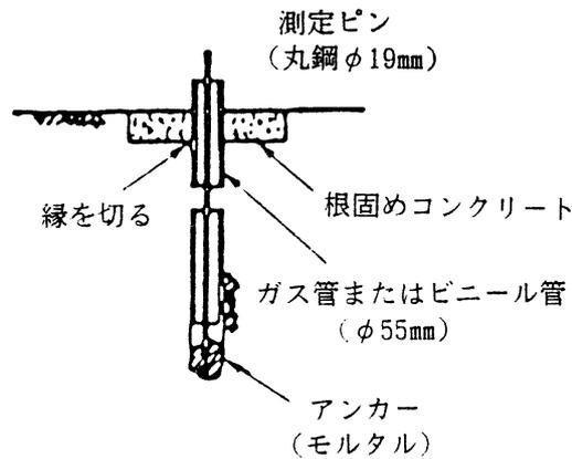
図 6 - 8 地中沈下測定点の設置例
