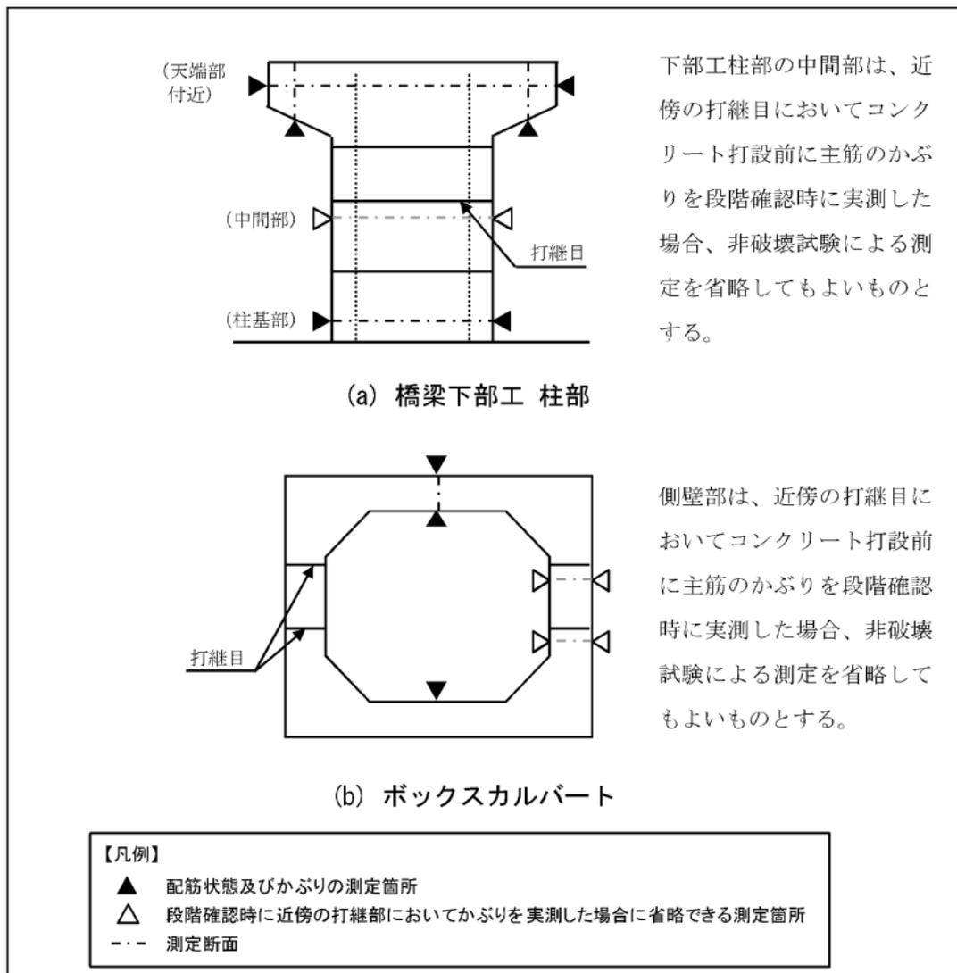
図9 非破壊試験による測定の省略
