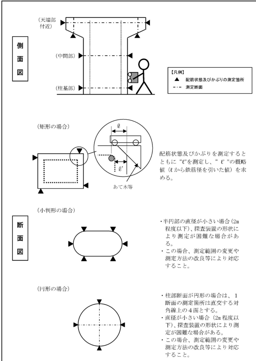
図6 橋梁下部工の測定位置 (例)
