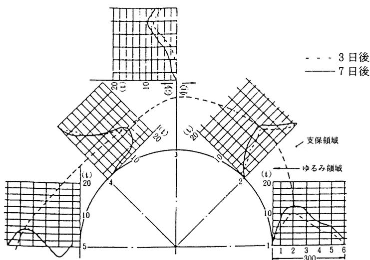
図6-3 ロックボルトの軸力分布
