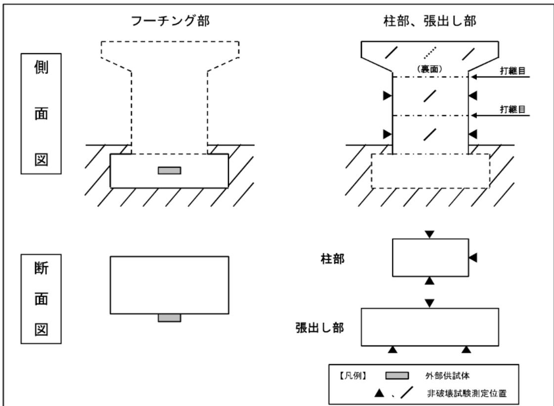
図4 橋梁下部工の測定位置（例）
