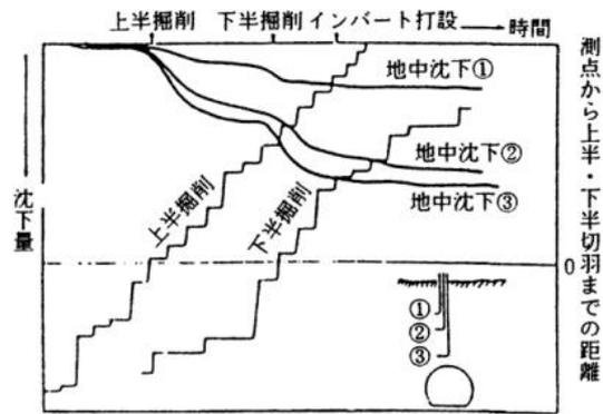
図 6-12 地中沈下量経時変化
