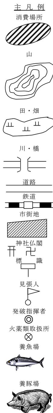
火薬類消費現場図には消費場所から周囲300メートルに至る範囲の建造物、公園、遊園地、鉄道、石油、ガスタンク、発電所、道路、高圧線、火工所、火薬類取扱所、火薬庫、その他構造物、施設等発破によって保護すべき物件との距離及び見張人、標識掲示、その他の位置を詳細に記入すること。
