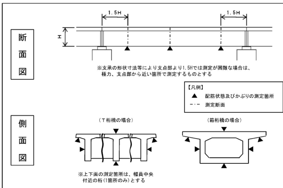
図5 橋梁上部工の測定位置（例）
