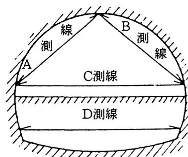
パターンD<sub>III</sub>, E, 坑口附近, 土被の浅い区間, 計測Bを実施する箇所
