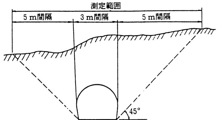
図 6-7 地表沈下 of 測定範囲及び間隔
