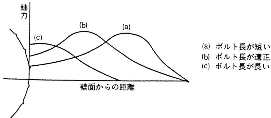
図6-4 ロックボルトの軸力分布
