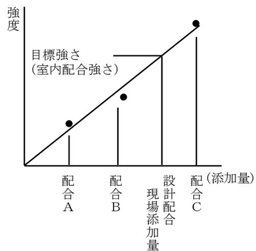
（目標強さに対応した添加量）とが一致しない場合が多い。そのため、室内配合試験のなかから、現場添加量に最も近い添加量の供試体（配合C）を選び、各土層（あるいは改良される土の各土質）ごとに供試体（材齢7日を基本とする）を1検体ずつ環境庁告示46号溶出試験に供する。
