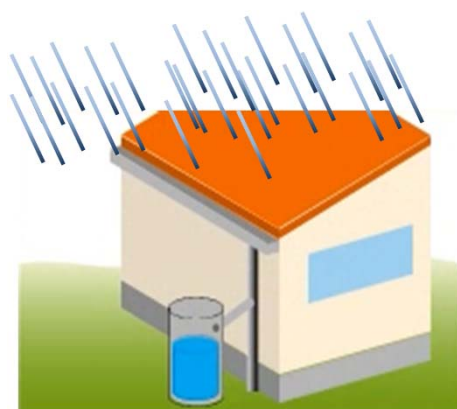
屋根に降った雨水を貯留
