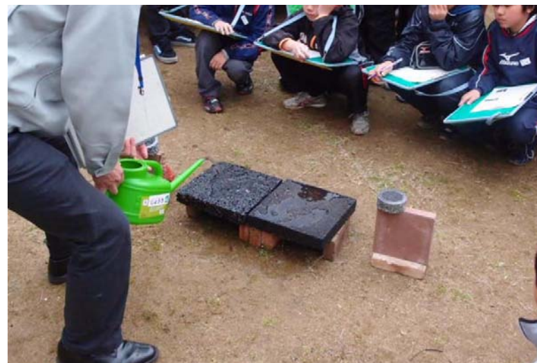
透水性舗装の違いを模型で実験
