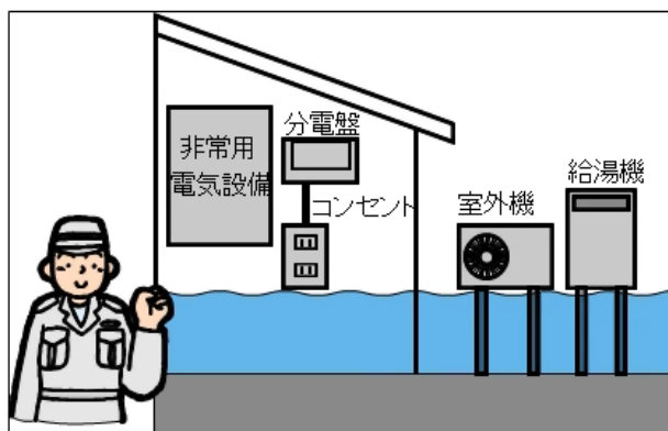
図 7.4.1 電気設備の浸水対策
