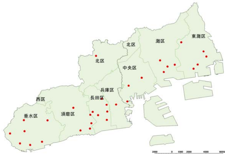
図 2.4.19 神戸市の雨水貯留槽整備箇所
