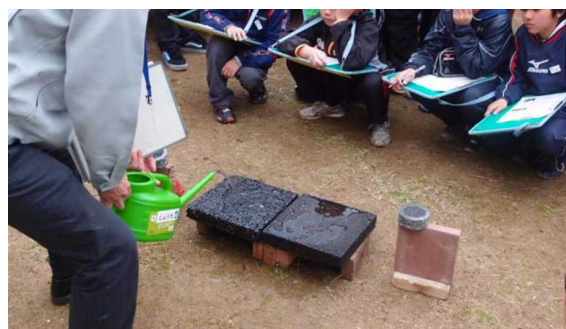
透水性舗装の違いを模型で実験
