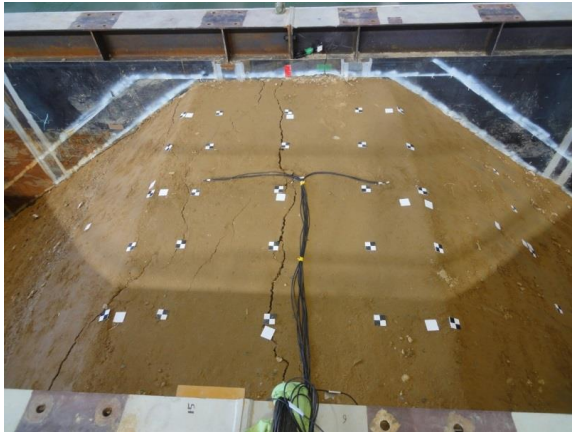
(a) 遮水シート工法の堤体天端
