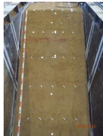
写真 23 前刃金下流法面クラック発生状況
