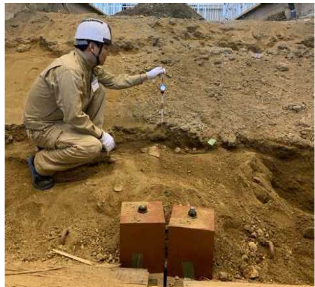
写真 5-10 2 段タイプ側法面の損傷状況
