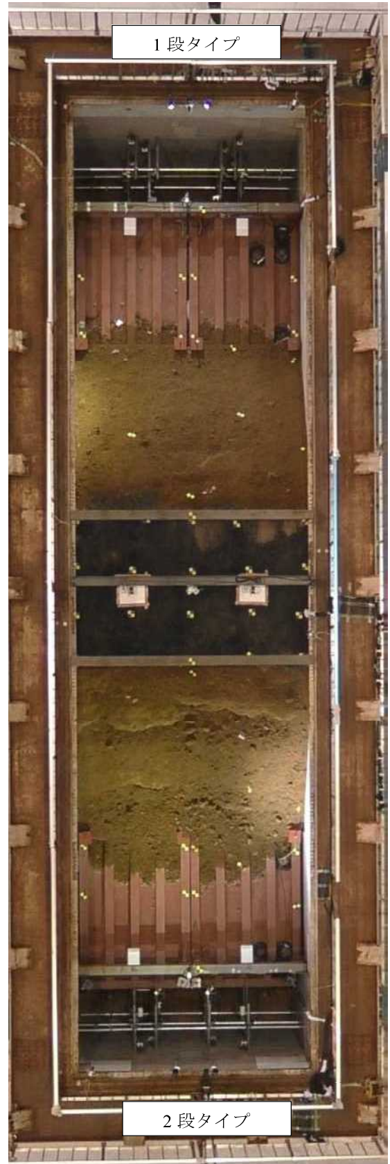
写真 5-4 加振後の盛土の様子 (加振条件 4, 最大 660Gal 相当波)
