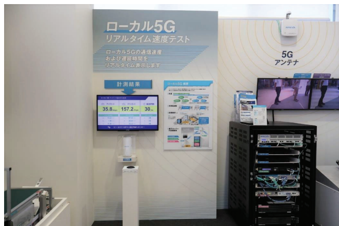
写真右側の黒色が基地局やコア、スイッチ等が入るラック (普段は表側のカバーは閉じているという)
