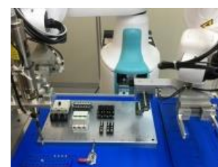
電気部品の取り付け作業を 協業ロボットの導入で自動化
