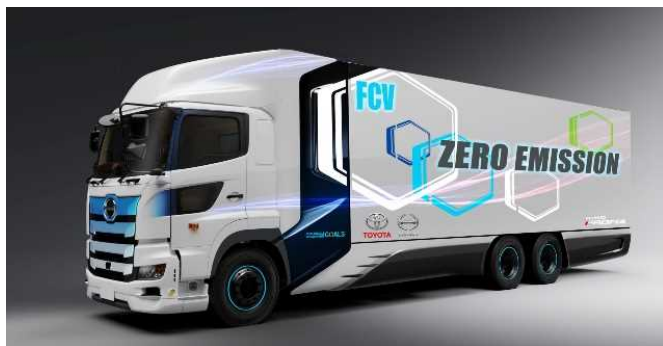
燃料電池大型トラック (トヨタ自動車・日野自動車共同開発) (出典)トヨタ自動車(株)、日野自動車(株)
