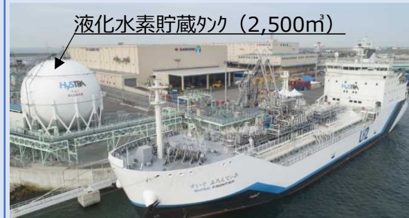
液化水素運搬船「すいそふろんていあ」 液化水素タンク（1,250m 3 ） HySTRA提供
