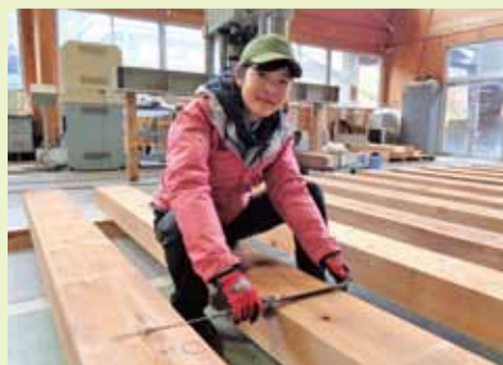
乾燥試験中の寸法測定
