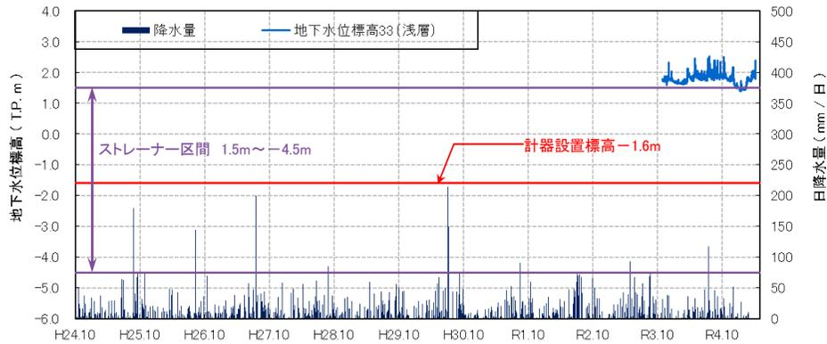
・地下水水位は標高1.8m前後が中心であるが、降雨の影響により敏感に変動する。令和4年12月～令和5年2月に護岸工事の影響で地下水低下がみられたが、回復傾向にある。
