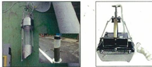
図 底質採取器概要（左図：HR式採取器 右図：エクマンバージ採泥器）
