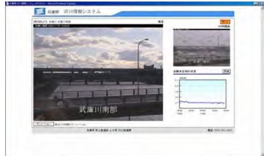
写真 4.1.4 河川監視カメラ画像の配信
