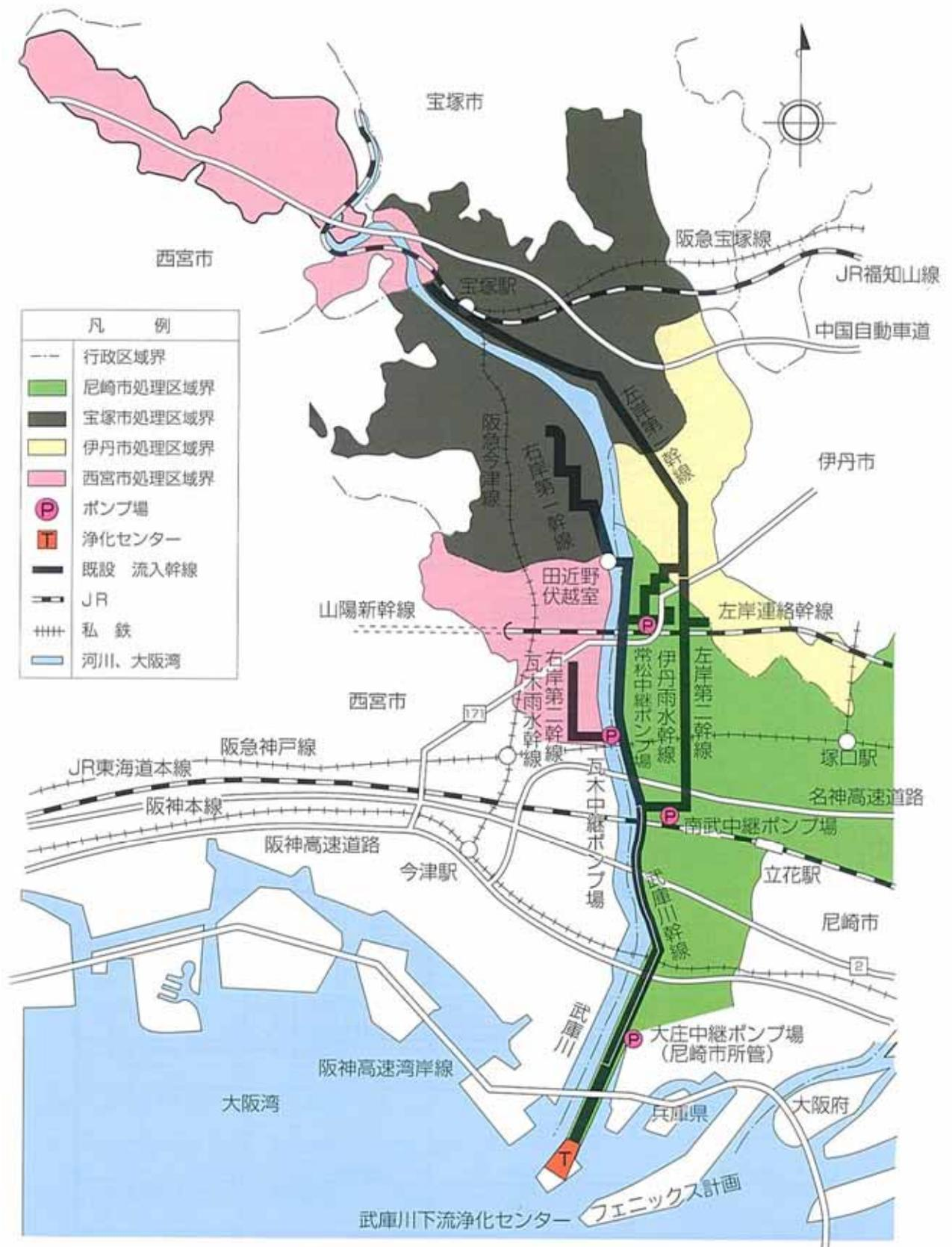
図 5.5.1 武庫川流域下水道計画平面図 (下流処理区)
