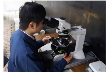
立入検査時のアスベスト測定
