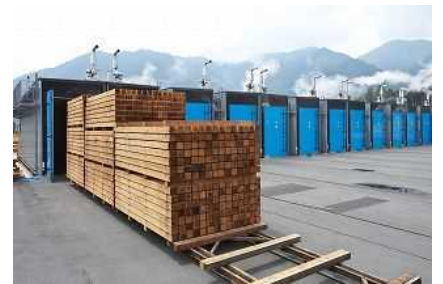
兵庫木材センター乾燥機 （宍粟市）
