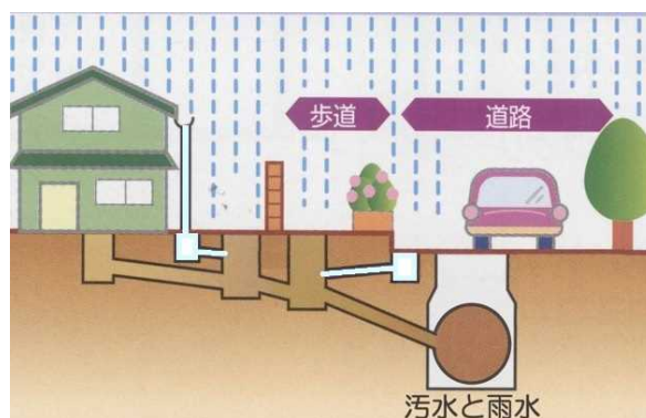
下水の排除方式 (分流式・合流式)
