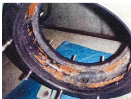
施設の劣化状況 (左：ポンプ内部の腐食 右：し渣乾燥機の腐食)
