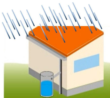
屋根に降った雨水を貯留
