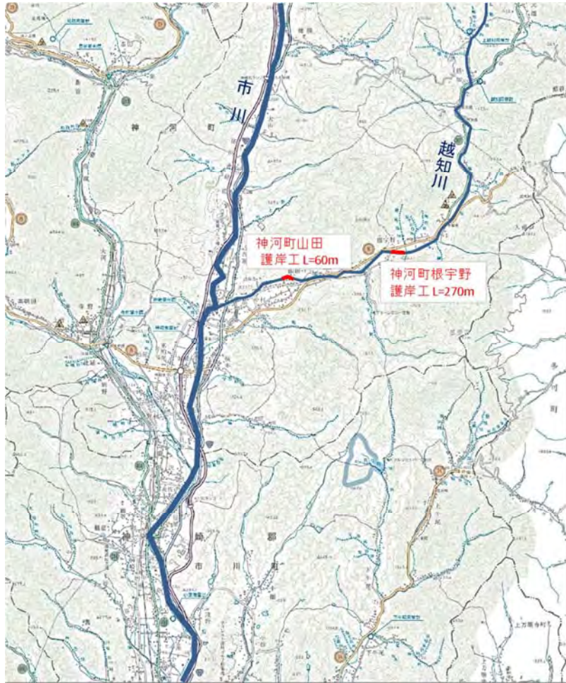
中上流部における緊急的な取組箇所（越知川）
