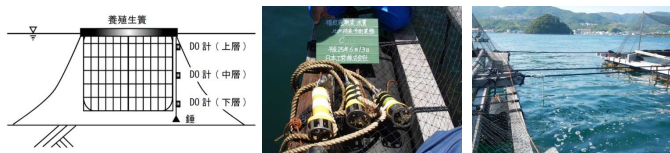
図 水質調査(連続調査)模式図・実施状況
