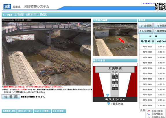
図 39 河川のリアルタイム監視画像例
