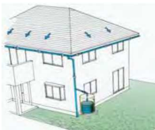
図 38 各戸貯留施設の例(地上タイプ)
